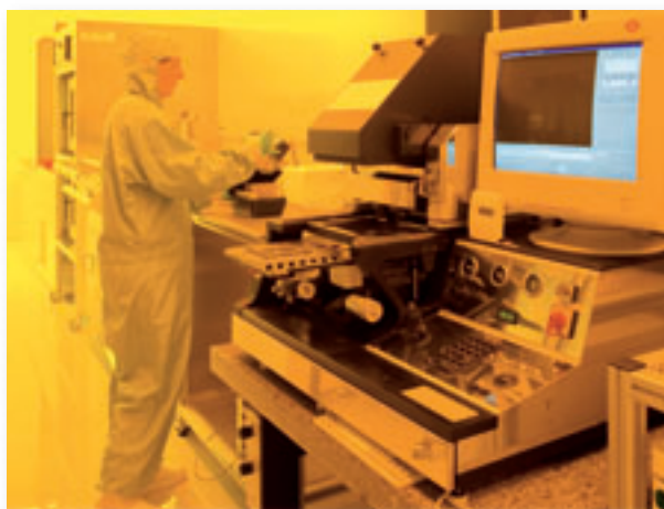
Photogravure : structuration de la couche de platine sur le substrat
