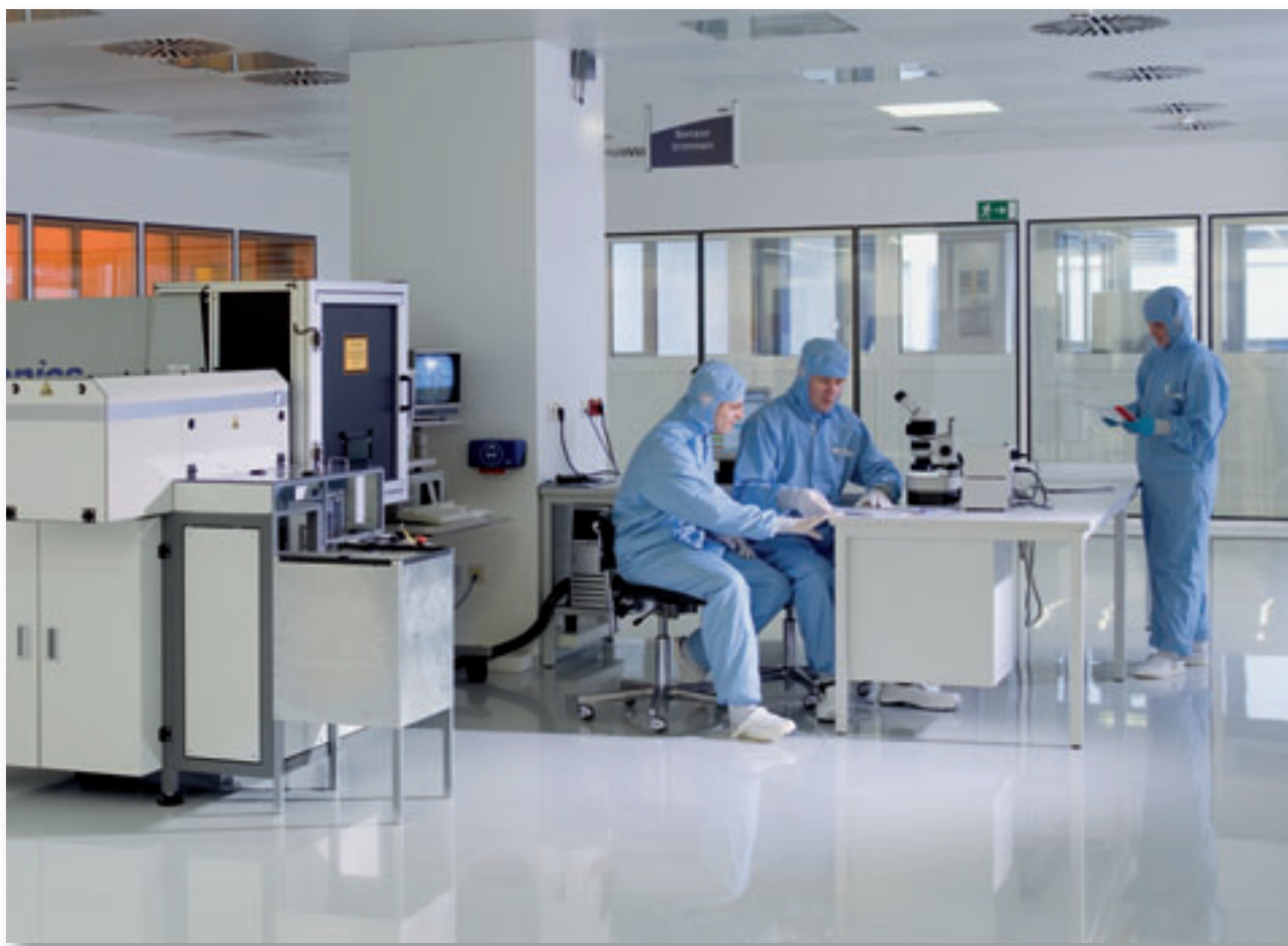
Production de sondes à résistance dans des conditions de salle blanche
