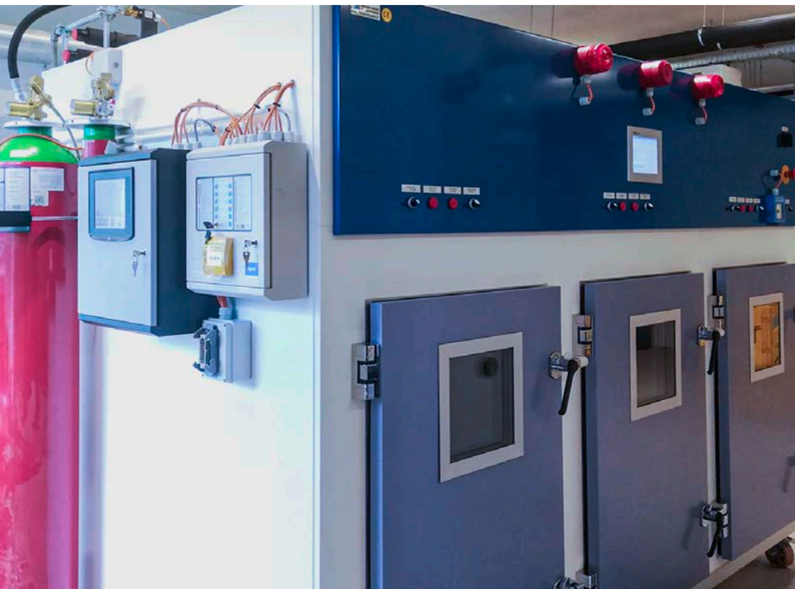
Batterijtester in geavanceerde klimaatkamer met PLC besturing van JUMO
