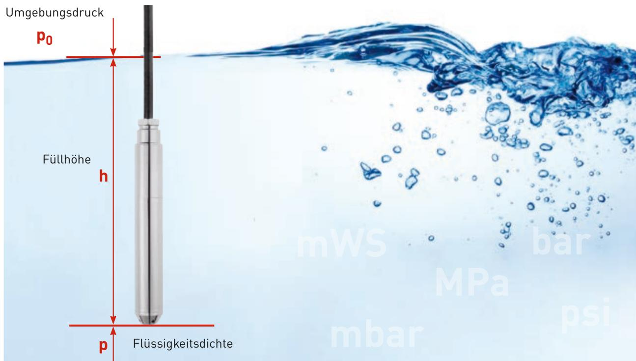
Berechnung des hydrostatischen Drucks:  $p = p_0 + \rho \times g \times h$
