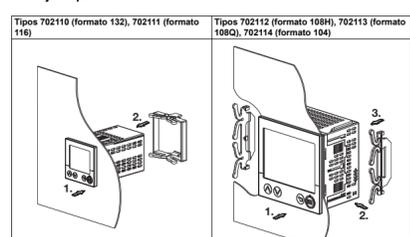
1. Introducir el instrumento en la parte delantera en el recorte del panel y poner atención a la posición correcta de la junta.
