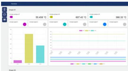
El servidor web permite al usuario representar diversos ajustes, valores de proceso y avisos mediante un navegador web.
