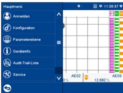
Die integrierte Benutzerverwaltung schützt den Bildschirmschreiber vor unberechtigtem Zugriff. In der Standardausführung werden bis zu 5 Benutzer mit unterschiedlichen Zugriffsrechten unterstützt. Mit dem Typenzusatz 888 (FDA 21 CFR Part 11) können bis zu 50 Benutzer verwaltet werden.
