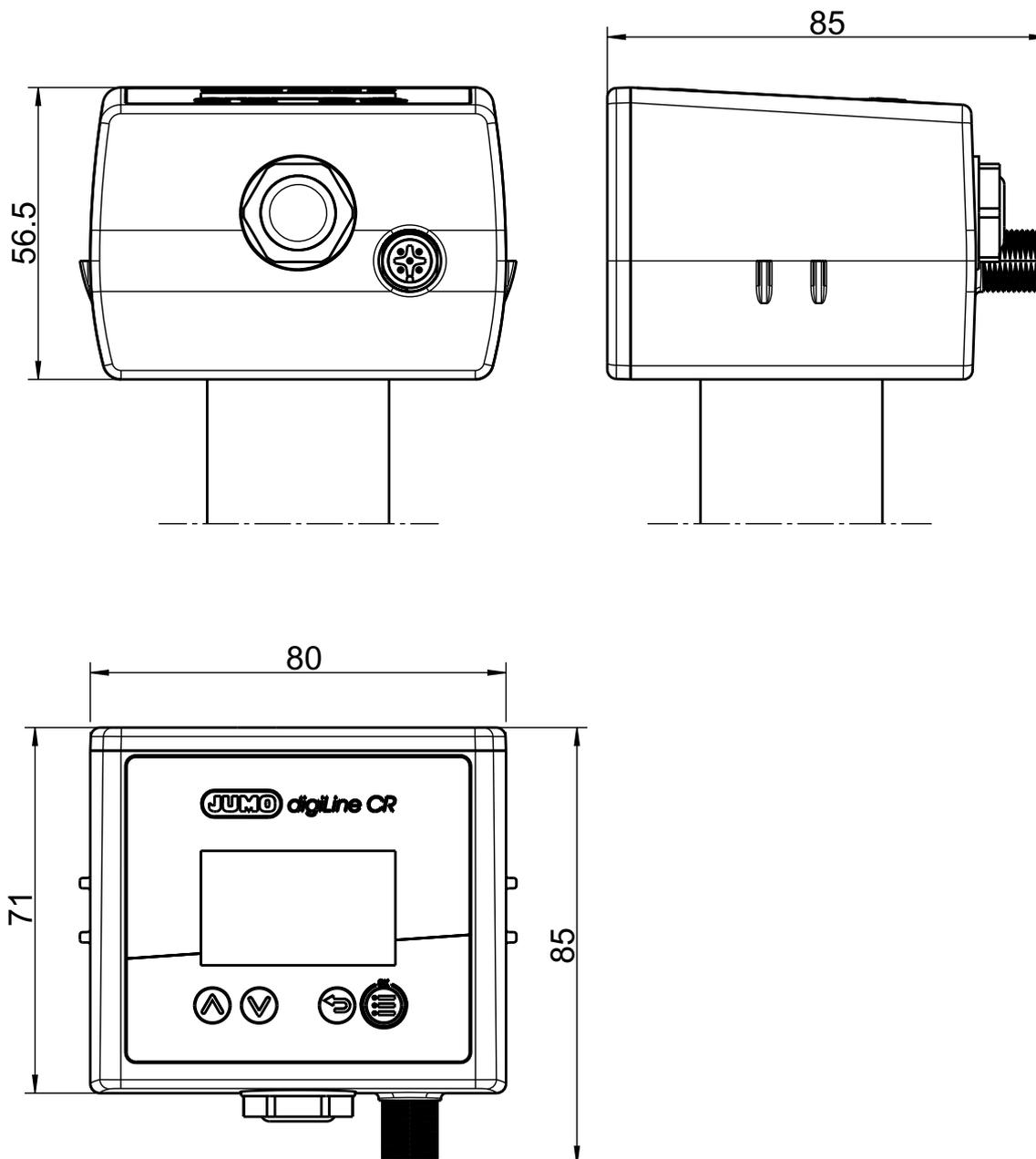
**Abmessungen JUMO digiLine-Elektronik mit Kunststoffgehäuse und Analog-/Binärausgängen**
