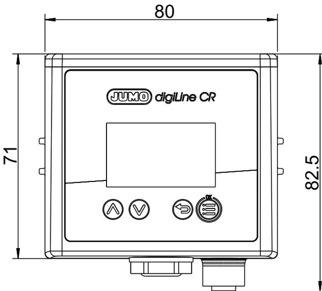
**Abmessungen JUMO digiLine-Elektronik mit Edelstahlgehäuse und digitalen Schnittstellen**
