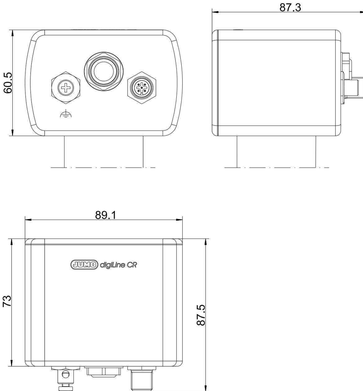
**Abmessungen JUMO digiLine-Elektronik mit Edelstahlgehäuse und Analog-/Binärausgängen**
