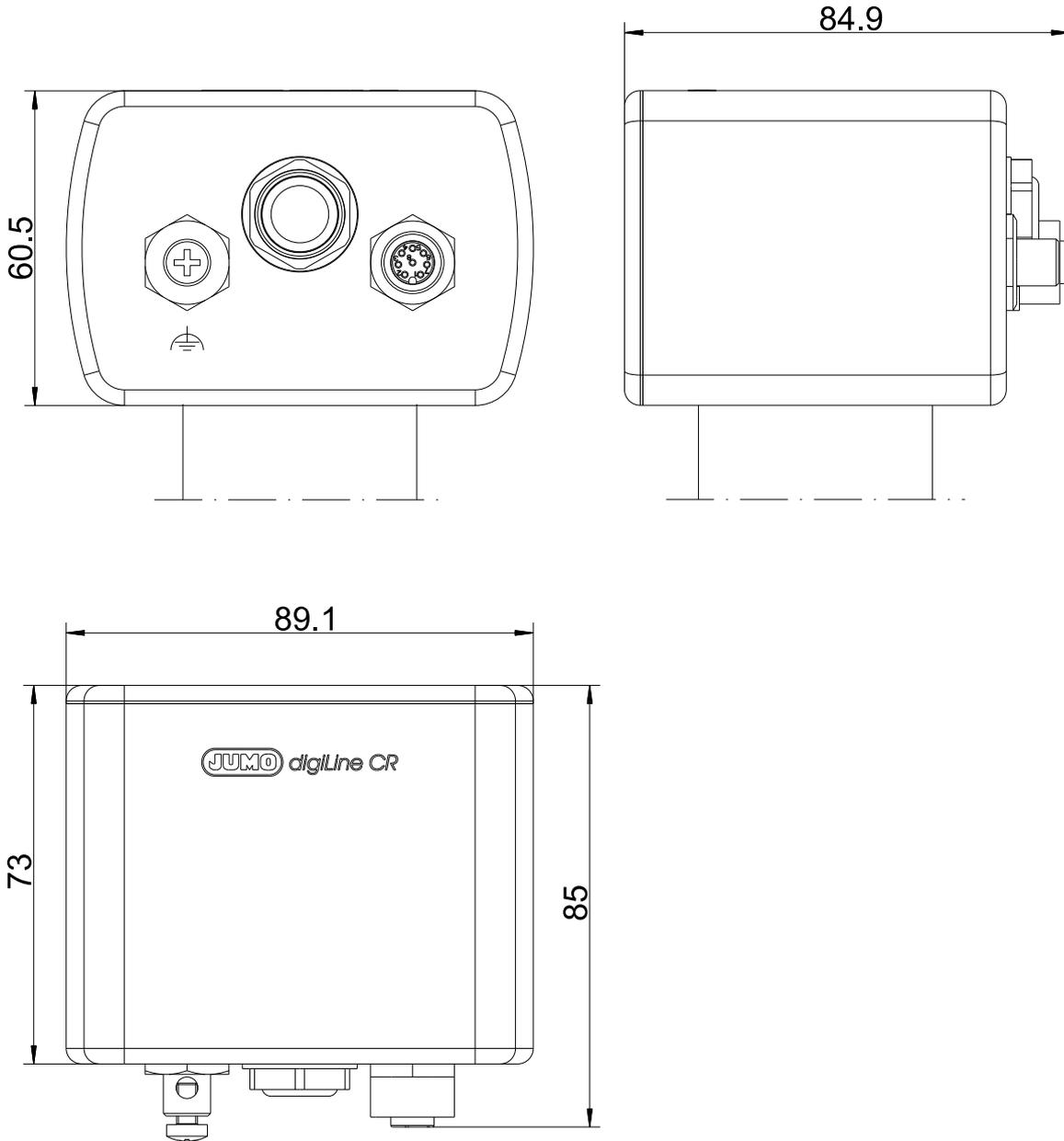
Die folgenden Maßzeichnungen bilden exemplarisch Kopfmessumformer mit Kunststoffgehäuse als Beispiele ab. Die angegebenen Maße gelten für alle erhältlichen Geräteausführungen mit Kunststoffgehäuse und Edelstahlgehäuse.
