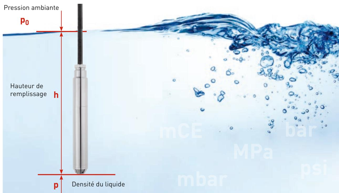
Calcul de la pression hydrostatique :  $p = p_0 + \rho \times g \times h$
