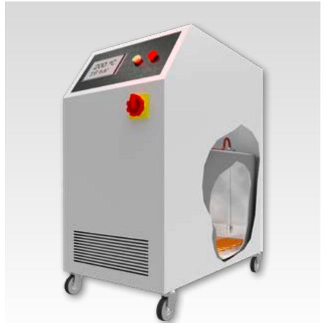
Le niveau de remplissage est au minimum
