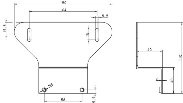
**Armature de passage, montée sur l'étrier de fixation**
