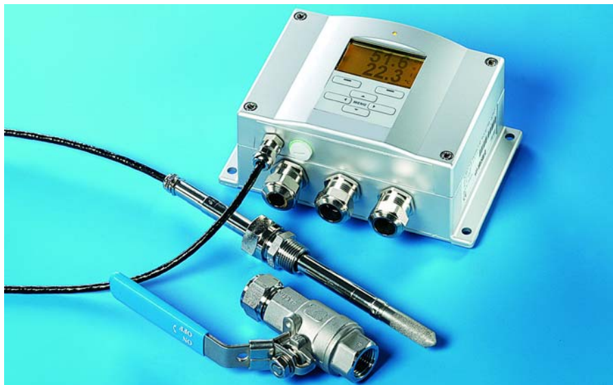
Snímač pro montáž do tlakového vedení a komor, odkud lze sonda demontovat bez přerušení provozu
