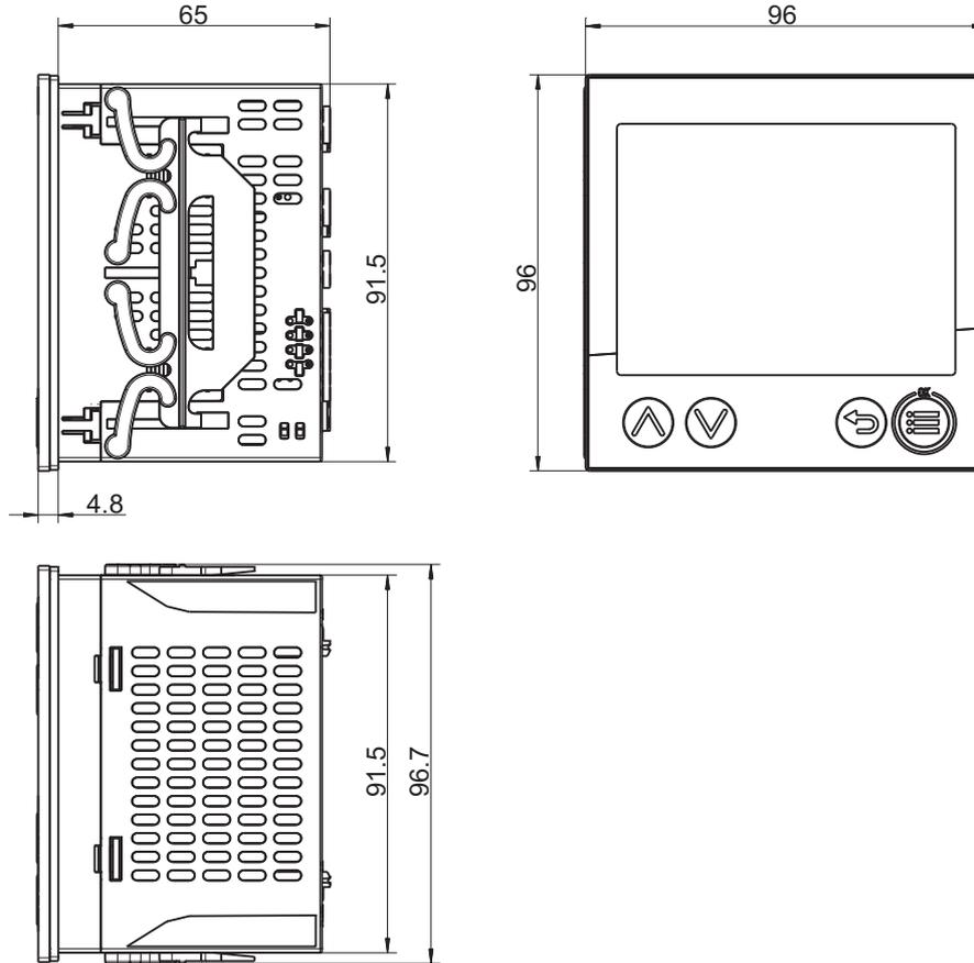
**Recortes del panel de mando según DIN IEC 61554**
