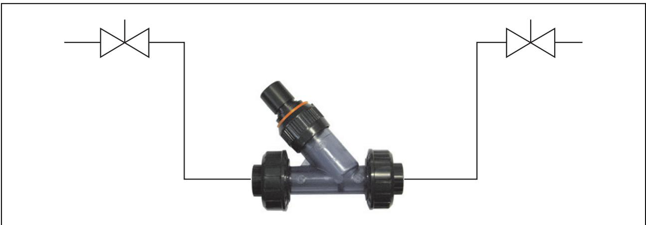
**Abbildung 25: Einbaubeispiel Schrägsitzarmatur Typ 202810/01**
