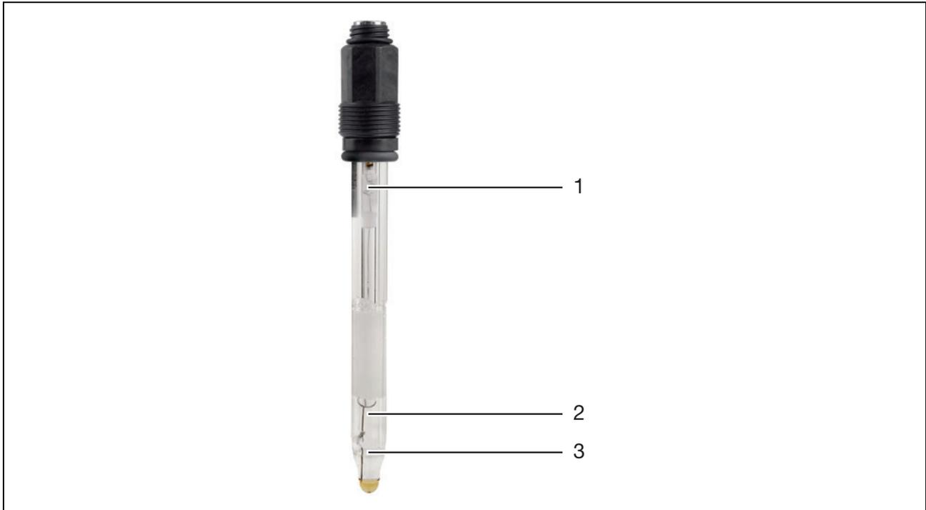
Abbildung 36: Bezugselektrode
