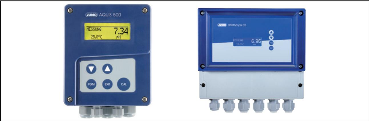
**Abbildung 29: JUMO AQUIS 500 pH - Messumformer/Regler für pH-Wert, Redox-Spannung, NH<sub>3</sub>-(Ammoniak)-Konzentration und Temperatur (links) und JUMO dTRANS pH 02 - Messumformer/Regler für pH, Redox, Ammoniak, Einheitssignale und Temperatur (rechts)**
