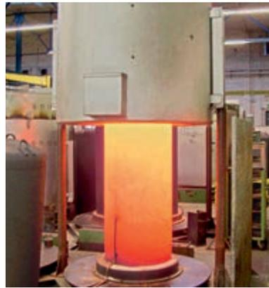
Four à cloche lors du retrait de la cloche chauffante pour le démarrage de la phase de refroidissement
