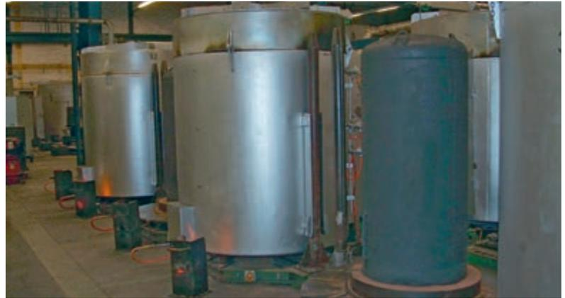
Four à cloche, en premier-plan sans cloche chauffante, à l'arrière-plan avec cloche chauffante
