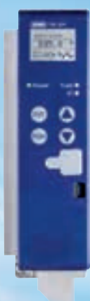
JUMO TYA-201 Eén-fasen vermogensregelaar voor aansturing van ohms inductieve lasten Type 709061
