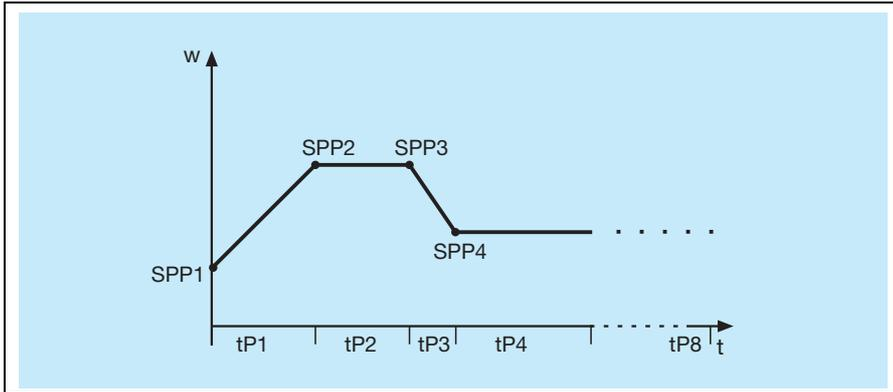
Il est possible de réaliser une courbe de consigne de huit segments maximum. La consigne (SPP1 à SPP8) et la durée (tP1 à tP8) de chaque segment sont réglées au niveau Commande. La base de temps est configurable : mm:ss ou hh:mm (s=secondes, h=heures).
