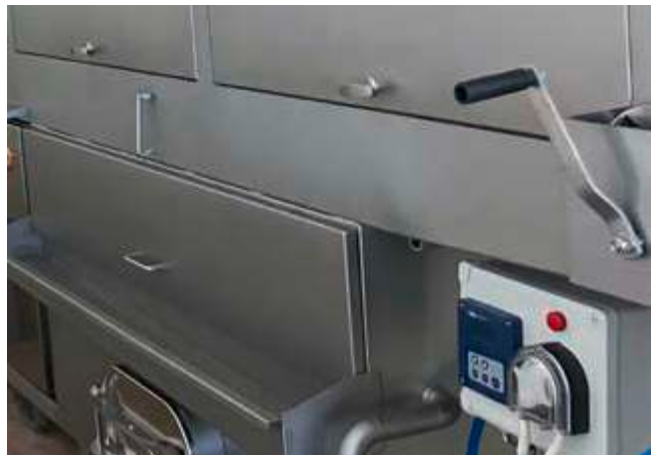
De JUMO AQUIS 500 regelt de juiste hoeveelheid reinigingsmiddel voor de doseerunit.
