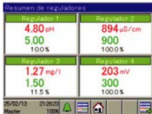
Figura 9. Ejemplo de la pantalla de 4 lazos de control PID.
