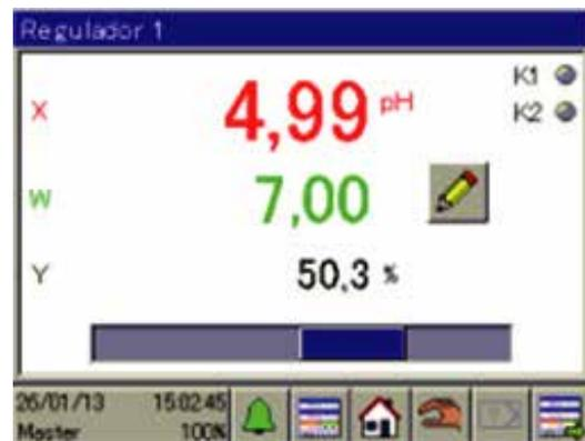
Figura 10. Ejemplo lazo PID individual. Rojo indica el valor del proceso, verde el setpoint, negro indica el porcentaje de salida del controlador.
