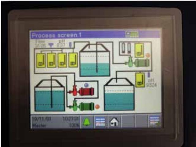
Figura 11. Ejemplo, pantalla de control multiparamétrico. En esta imagen el equipo se encuentra controlando 3 motores y 6 bombas dosificadoras, mediante salidas de relevador.
