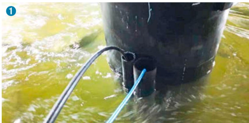
❶ JUMO MAERA niveausensor (zwarte kabel) in de groeibassins van Kingfish Zeeland
