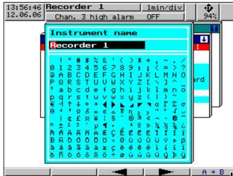
Selecione o caractere a ser alterado utilizando as teclas de função
