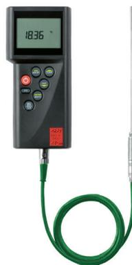
**Abb. 70: Referenzthermometer in Ausführung mit Thermoelement**
