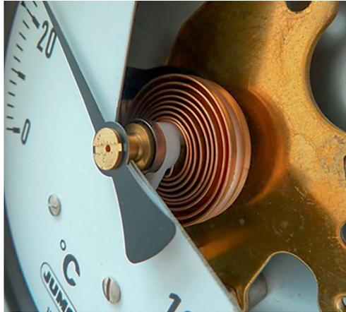
**Abb. 2: Blick hinter die Skala eines Zeigerthermometers mit Kapillarmesssystem (flüssigkeits- oder gasgefüllt, mit Bourdonfeder)**
