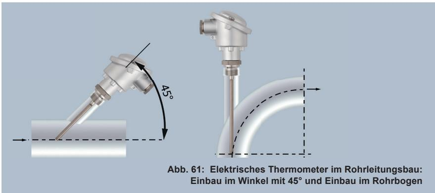
Abb. 61: Elektrisches Thermometer im Rohrleitungsbau: Einbau im Winkel mit  $45^\circ$  und Einbau im Rohrbogen
