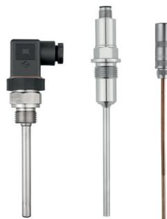
**Abb. 51: Widerstandsthermometer mit Anschlussstecker nach DIN EN 175301-803, Rundstecker M12, 1 × 5-polig, nach IEC 60947-5 und Lemo®stecker**
