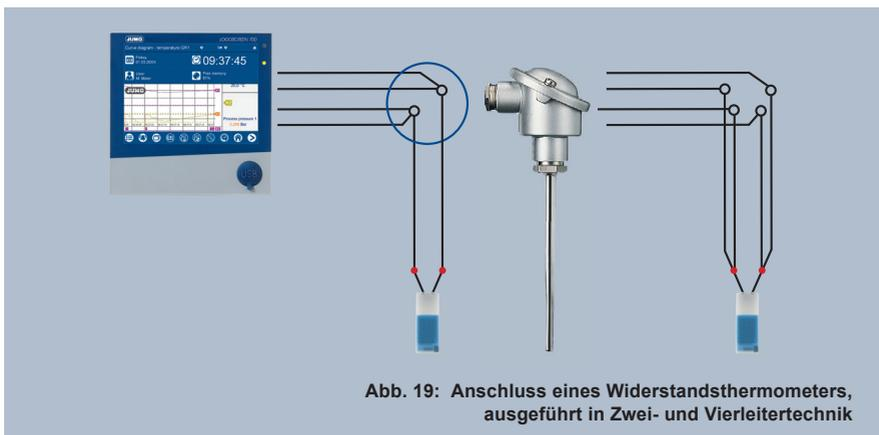
Abb. 19: Anschluss eines Widerstandsthermometers, ausgeführt in Zwei- und Vierleitertechnik
