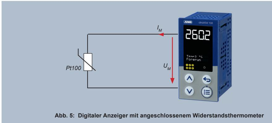
Abb. 5: Digitaler Anzeiger mit angeschlossenem Widerstandsthermometer
