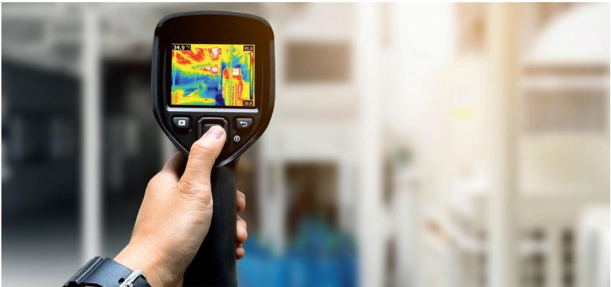
Abb. 4: Strahlungspyrometer
