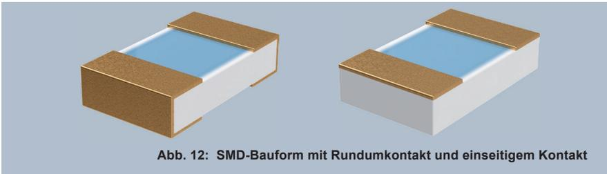
In der Regel finden SMD-Sensoren mit Rundumkontakt Verwendung (Abb. 12, links). Die Ausführungen mit einseitigem Kontakt (Abb. 12, rechts) bieten einen hohen Isolationswiderstand durch die Isolierung von der Platine abgewandten Seite. Diese Variante ist prädestiniert für enge Platzverhältnissen.
