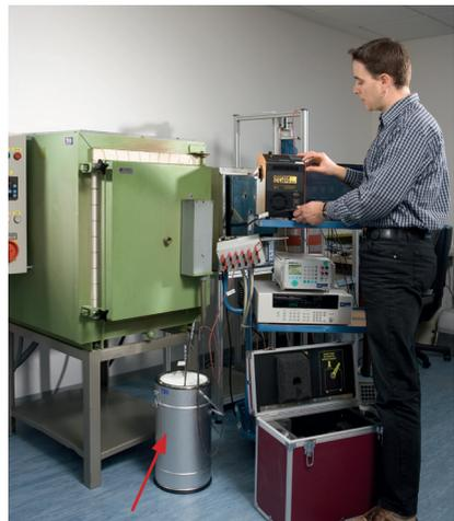
**Abb. 38:** Einsatz eines Dewargefäßes für Vergleichsstellentemperatur von  $0\text{ }^{\circ}\text{C}$
