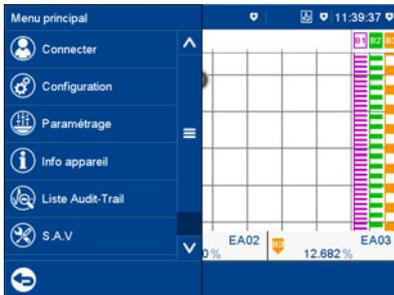
La gestion des utilisateurs intégrée protège l'enregistreur sans papier d'accès non autorisés. La version standard prend en charge jusqu'à cinq utilisateurs avec des droits d'accès différents. L'option 888 (FDA 21 CFR Part 11) permet de gérer jusqu'à 50 utilisateurs.
