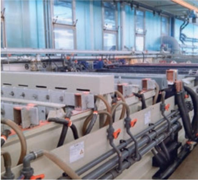
Säure-Tauchbäder der Firma DIENER &amp; RAPP
