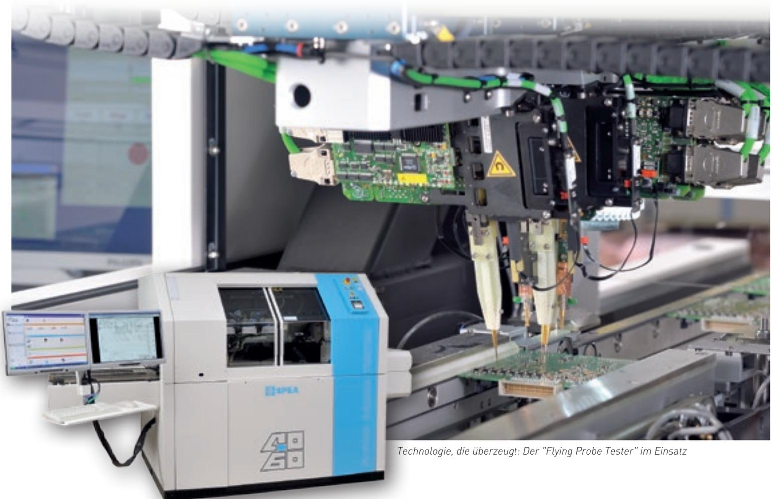
Technologie, die überzeugt: Der "Flying Probe Tester" im Einsatz
